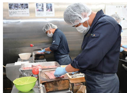
自社開発のうなぎ串打ち機で効率的に串打ちし、職人が手直して丁寧に仕上げる
